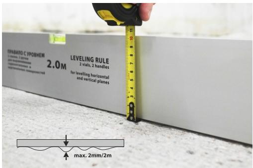
**4.7** При проверке выравнивающего слоя контрольным 2-метровым правилом, передвигаемым во всех направлениях, необходимо проводить не менее девяти измерений на каждые 50-70 м<sup>2</sup>. **Отклонение поверхности выравнивающего слоя от плоскости не должны превышать 2 мм.**
