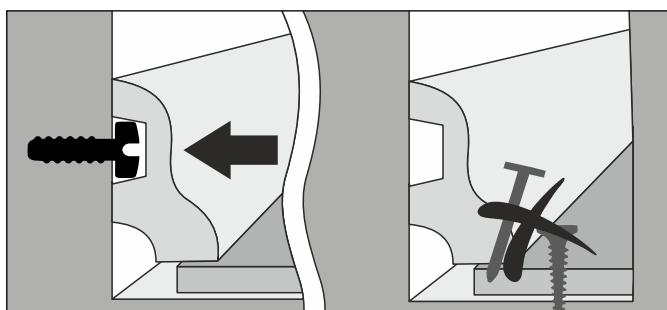
7.13 Плинтус крепится к стене. Следите за тем, чтобы плинтус не был жёстко закреплён на поверхности кварцевого паркета и обеспечивал подвижность, не фиксируя напольное покрытие.
