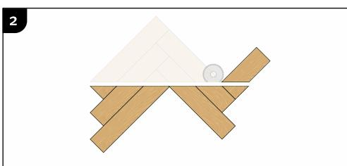
Демонтируйте лишние части плашек с первых треугольников. Используйте их для монтажа открытых частей пола вдоль стены. Укладывайте плашки у стены с учетом зазора для расширения 10 мм.
