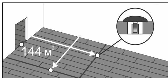
7.10 Площадь максимально возможной беспороговой укладки до 144 м<sup>2</sup> при условии, что максимальная длина и ширина беспрерывного ряда должна составлять не более 12 м. При отсутствии разрывов в укладке кварцевого паркета в дверных проемах общая длина или ширина – это сумма длин или ширин всех комнат.
