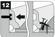
Плинтус крепится к стене. Следите за тем, чтобы плинтус не был жёстко закреплён на поверхности кварцевого ламината — это может привести к деформации покрытия.
