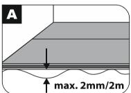
Неровности основания, превышающие 2 мм на 2 м длины укладки,
