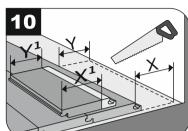
Возможно, придётся обрезать последний ряд - для более качественной укладки измеряйте ширину элемента с двух сторон, учитывая деформационный зазор 6-8 мм.
