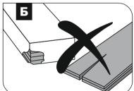
Пожалуйста, проверяйте купленные пачки: они должны быть целыми и не иметь повреждений. Поврежденные плашки нельзя использовать при укладке.
