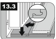
Сдвиньте плашки кварцевого ламината под выступающую помеху и, плотно прижав, соедините с плашками предыдущего ряда.
